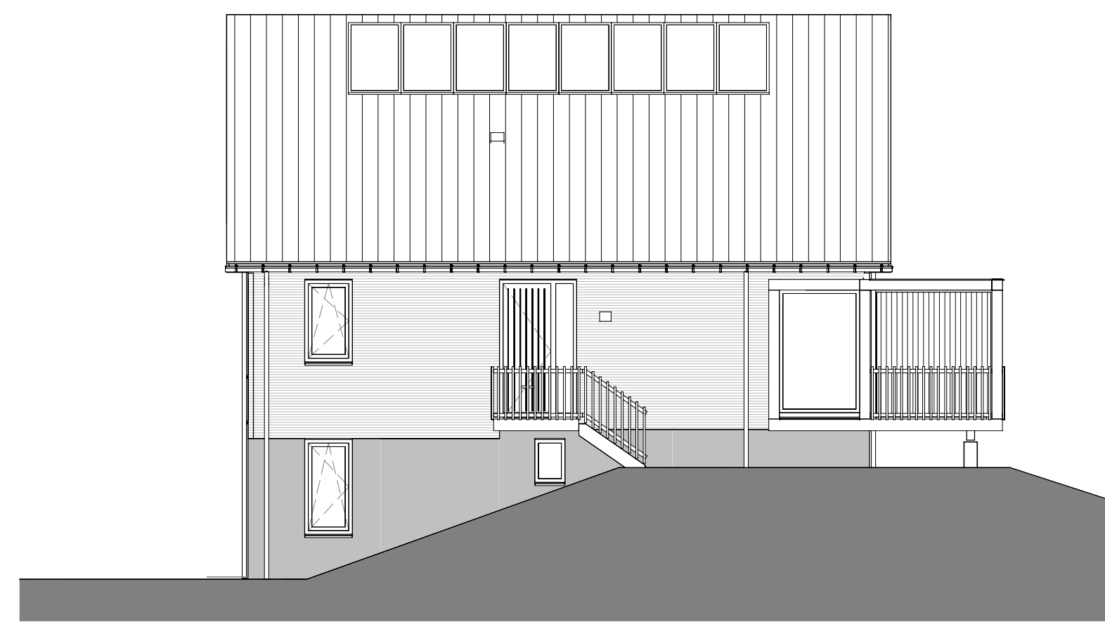
linker zijgevel schaal 1 : 100 Verloop talud is indicatief, de gemeente maakt het terrein voorwerp. Verloop kan nog wijzigen.
